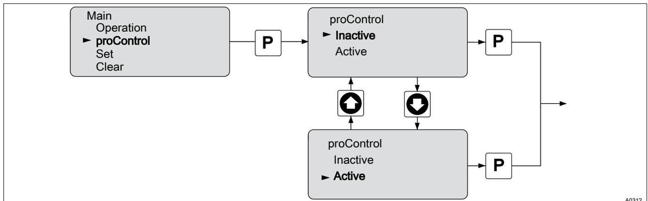
Fig. 14: Activate/deactivate control module delta<sup>®</sup>
