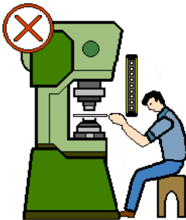
Penetrazione da sotto la barriera
