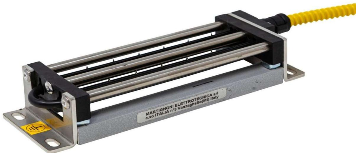
La barra antistatica Tipo E viene utilizzata per eliminare e neutralizzare le cariche elettrostatiche in molteplici settori ed ha una struttura in alluminio con anima in PVC autoestinguente. La presenza di due file di elettrodi garantisce elevate prestazioni. La barra Tipo E viene realizzata su misura in base alle esigenze del cliente ed ha efficacia da 10 mm a 300 mm.
