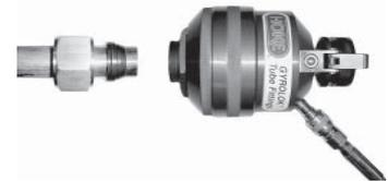
Nach der Montage. Die Einheit kann nun nach der Wiedermontagsvorschrift im Verschraubungskörper montiert werden.
