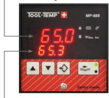
Isttemperatur / effektive Temperatur in <sup>1</sup>/<sub>10</sub>°-Auflösung
